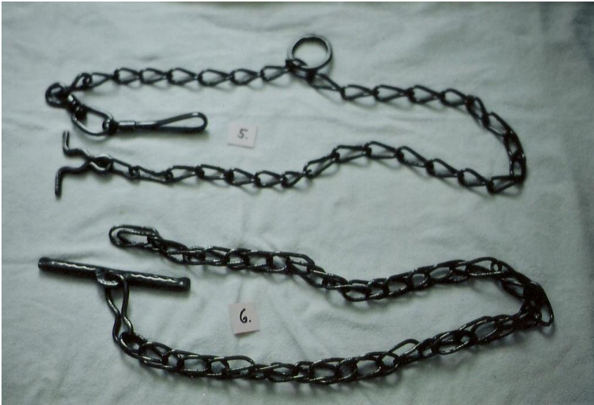
Heimgeschirrschmiede Albert, Frömern; Fertigungsteile (beispielhaft): (5) Ziegenkette mit Sicherheitsknebel, Ring und Federhaken, (6) doppelgliedrige Kuhkette; Foto: Verf.
